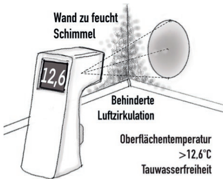
[ 4 ] Abbildung: Messung der Mindestoberflächentemperatur mit einem Infrarotthermometer/Pyrometer
